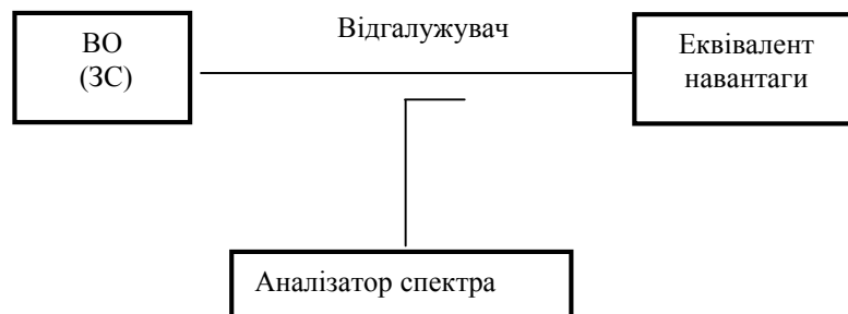
Рисунок 9.7 – Схема вимірювання густини вихідної потужності передавача
