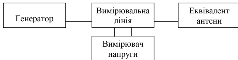
Рисунок Ж.1 – Вимірювання КСХ еквівалента антени з використанням вимірювальної лінії
