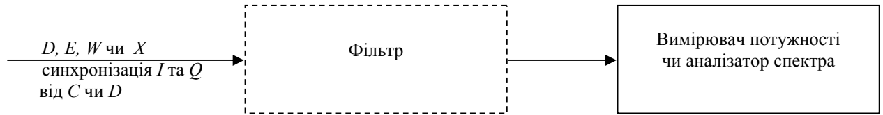
Рисунок Р.3 – Випробувальна установка для вимірювання потужності РЧ/ПЧ
